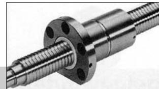
Ausführung: Zylindrische Mutter nach DIN 69051 mit Schmierbohrung und Paßfedernut
